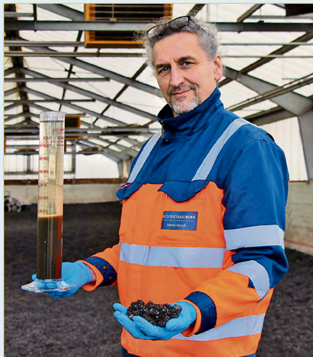
Abwassermeister Martin Morzik zeigt an der Kläranlage Bredstedt den flüssigen Schlamm nach der abgeschlossenen Abwasserbehandlung und das Granulat am Ende der Trocknung. Die Menge in der Hand entspricht etwa zehn Litern flüssigem Schlamm.
